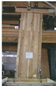
図1 耐力壁パネルの概要 写真1 パネルの強度試験
